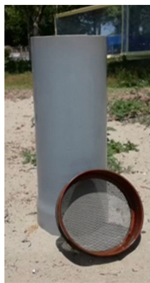
Εικόνα 1. Ένας πυρηνοδειγματολήπτης PVC (διάμετρος 20 cm)
