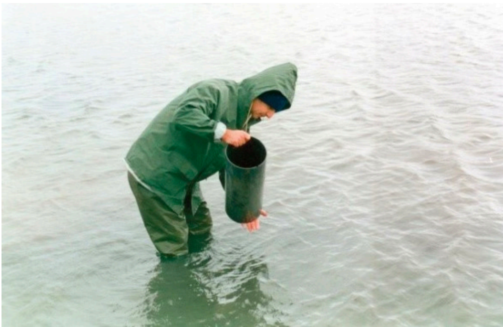
Εικόνα 2. Δειγματοληψία θαλάσσιου αγγειόσπερμου με χρήση πυρηνοδειγματολήπτη
